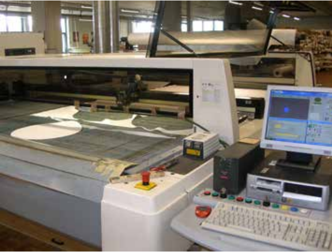
Lasercutter CAD-gesteuert. Schnittbreite bis 248 cm.
