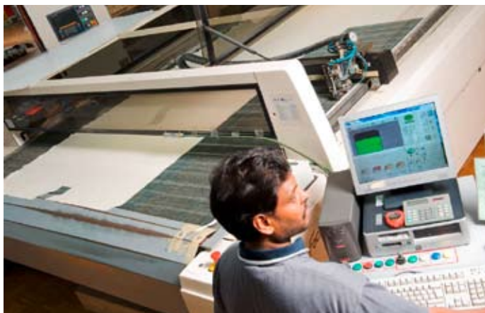
Hightech-Lasercutter CAD-gesteuert. Schnittbreite bis 248 cm.
