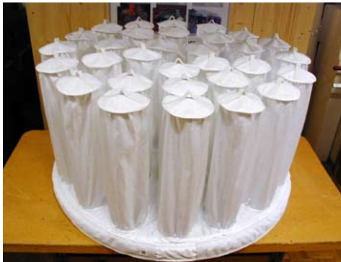
Im Hause konfektionierter Wirbelschichttrockner mit antistatischem Gewebe.
